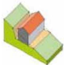
La maison sur un décaissement du terrain trop important oblige à tenir le talus arrière par un **mur de soutènement lourd et coûteux**. Ce type d'implantation **réduit considérablement l'apport de lumière naturelle** dans les pièces d'habitation.
